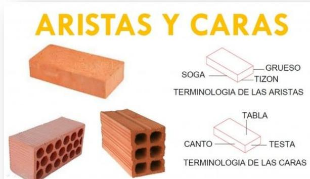
Para construir un muro de ladrillo se emplea mortero, formado por cemento, agua y arena. Cada línea horizontal de ladrillos se llama *hilada*. Primero se coloca una primera hilada. Cuando se comienza la superior, se hace con la mitad de un ladrillo así se consigue que las juntas verticales entre una hilada y la superior queden separadas medio ladrillo.
